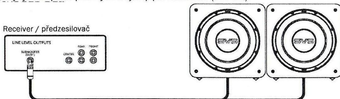
Další možností je použít levý a pravý RCA výstup na dalších subwooferech SB-2000 Pro pro sériové zapojení (Daisy Chain). Je důležité použít odpovídající výstupní a vstupní svorky. Například, pokud používáte RCA vstupy, ujistěte se, že používáte RCA výstupy k sériovému zapojení s dalším subwooferem.
