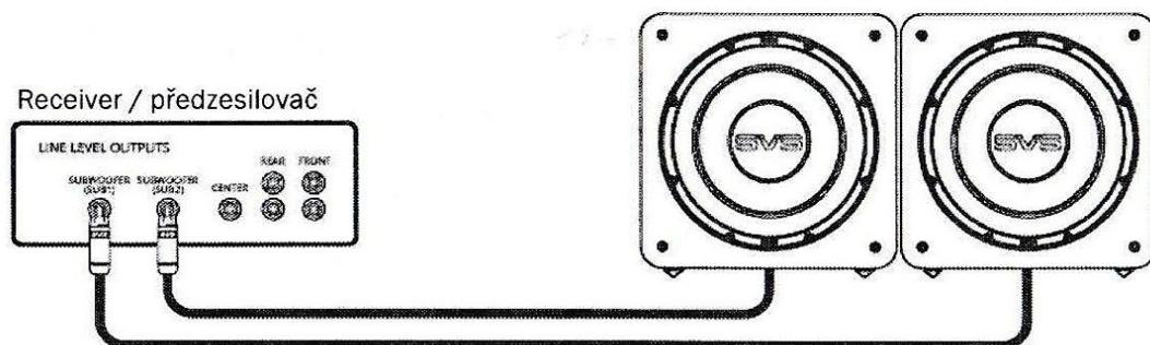
Pokud máte více subwooferů než dílčích výstupů z vašeho AV receiveru, snadným řešením je použít k rozdělení výstupu subwooferu RCA rozbočovač nebo RCA Y-adaptér. Toto je nejčastěji doporučovaný způsob připojení více subwooferů, když je k dispozici pouze jeden výstup pro subwoofer (Sub Out).
