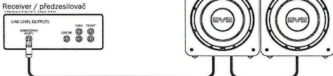
Ve 2kanálovém systému můžete nastavit stereo subwoofery, kde jeden bude používán pro levý kanál a jeden pro pravý kanál. Subwoofery jsou obvykle umístěny symetricky podle vašich reproduktorů. Ujistěte se také, že udržujete všechna správná levá a pravá výstupní a vstupní připojení, abyste zajistili optimální výkon.
